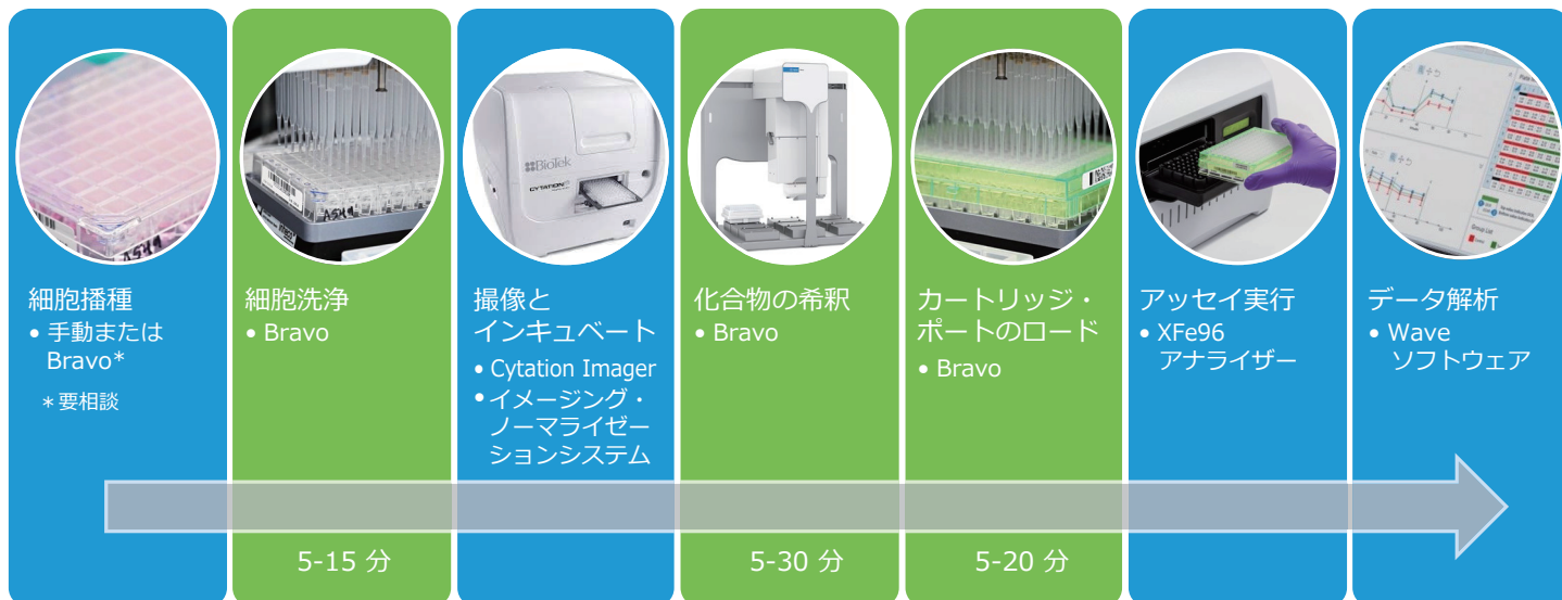
Figure 1：一般的なSeahorse XF Assayワークフロー。Bravoで自動化されるサンプル調製ステップ：洗浄細胞、インジェクション溶液の調製、Seahorse XFe96センサーカートリッジのローディングは緑で示される。1プレートにつき20~60分の手動操作時間を削減する。
